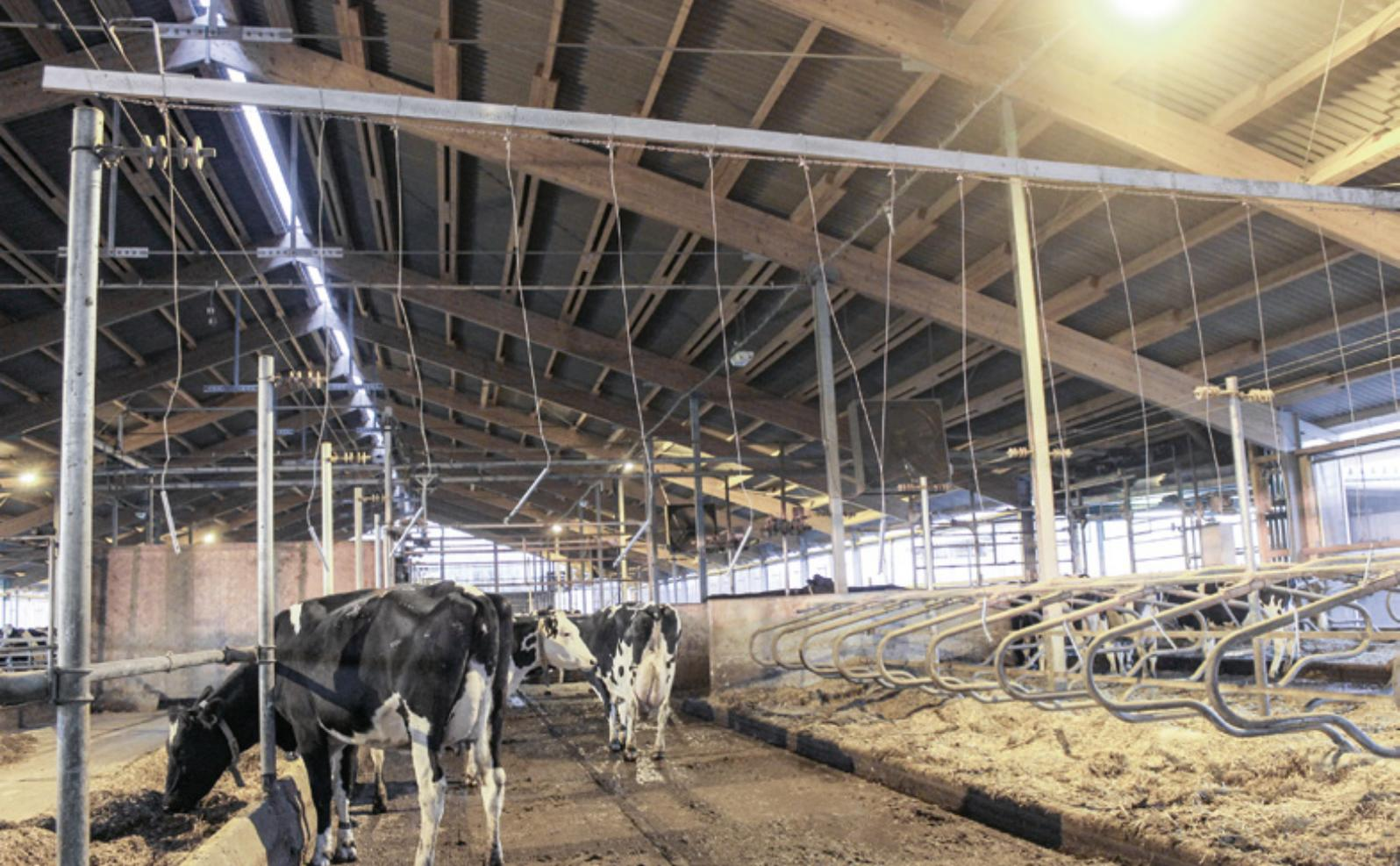
*In jeder der vier Gruppen bringt ein schienengeführter Kettenvorhang die Kühe bis zum Mittelgang und „übergibt“ sie an den nächsten Treiber, der sie in den Warteraum bringt. Der erste Treiber startet zu einer festgelegten Uhrzeit, danach geht es abhängig vom Durchsatz im Melkstand weiter.*
